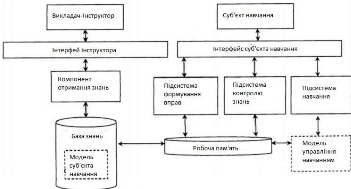
Рис.1. Клієнт-серверна функціональна схема прототипу АНС «Диспетчер Tower»
