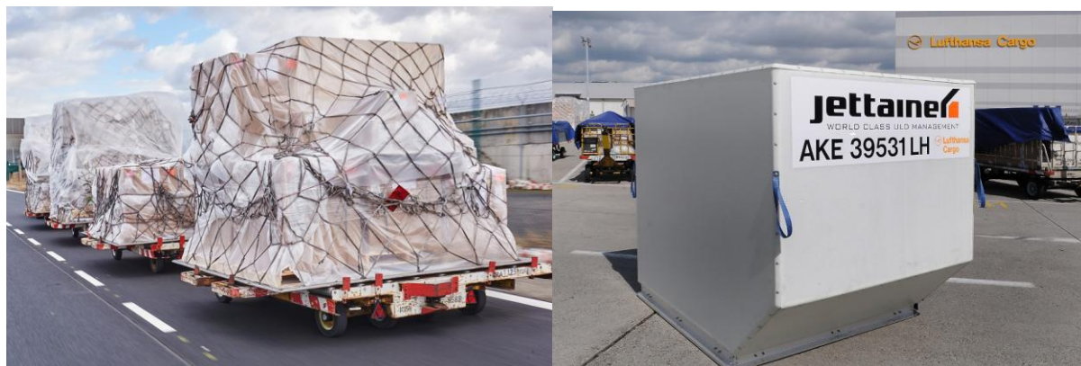
Рис. 2 Палети типу РМС з імітацією контуру головного вантажного відсіку (зверху). Контейнер типу АКЕ до нижнього вантажного відсіку (знизу).
