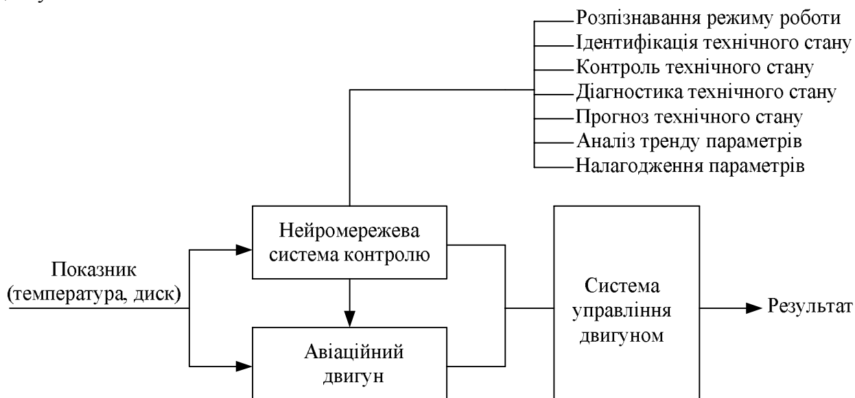
Рис. 1. Структурна схема автоматизованих системах управління авіаційними двигунами з використанням нейромережевих технологій
