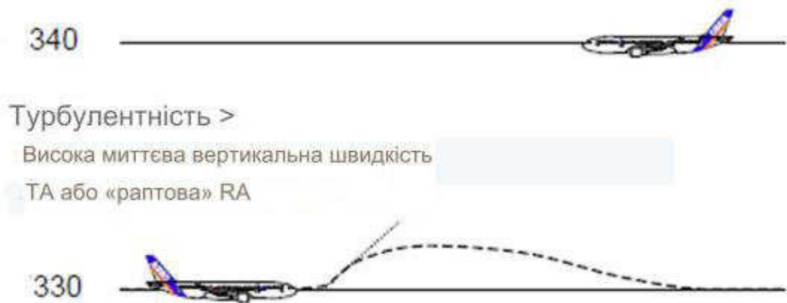
Рис.2.4 Вплив турбулентності на траєкторії повітряного судна у вертикальній площині
