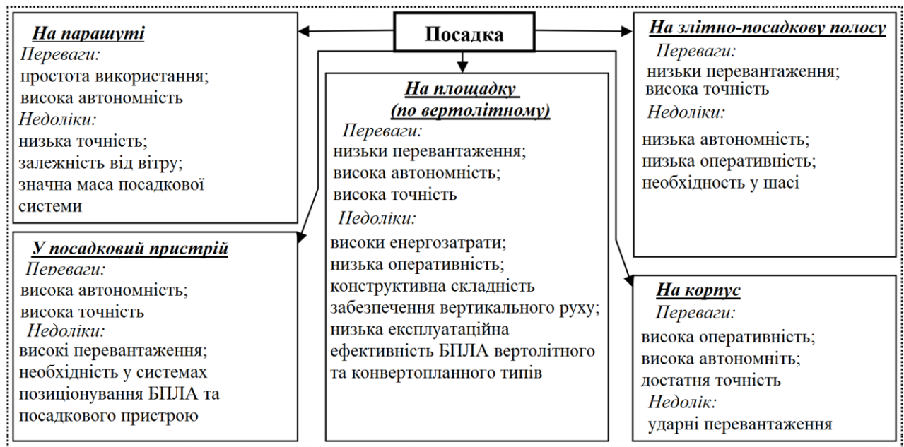
Рисунок 3.8 - Основні варіанти посадки БПЛА в залежності від експлуатаційних особливостей
