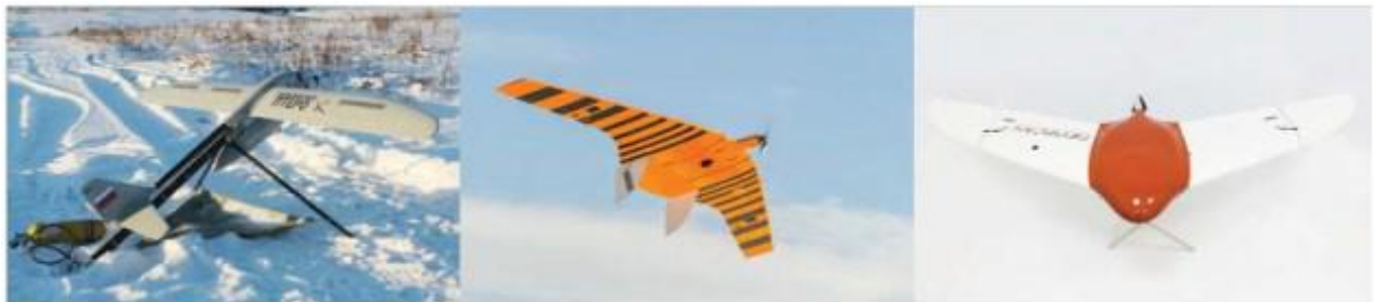
Рисунок 2.3 - Основні БПЛА літакового типу, що використовуються для обстеження повітряних ЛЕП
