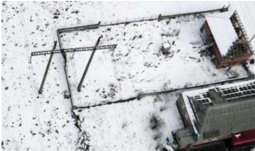
Рисунок 2.2 - Виявлення порушення охоронної зони повітряних ліній за допомогою БПЛА
