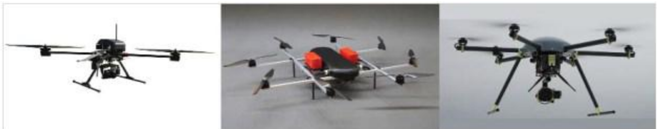
Рисунок 2.4 - Основні БПЛА мультироторного типу, що використовуються для обстеження повітряних ЛЕП.
