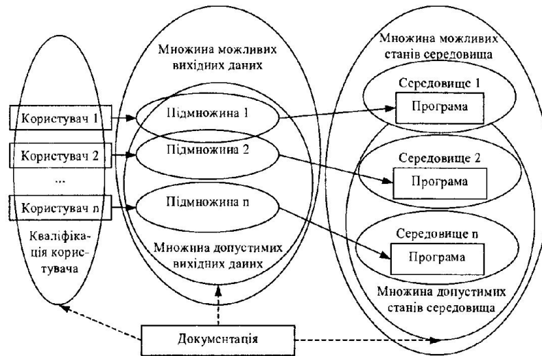
Рисунок 3.1 – Кортеж прикладної програми (як спрощеного варіанту ІС): сама програма; режим експлуатації (вихідні дані та кваліфікація користувача); середовище експлуатації (апаратна конфігурація обладнання, системне програмне забезпечення (операційна система) та прикладне програмне забезпечення); документація, (визначає допустиму множину вихідних даних, середовища, а також необхідну кваліфікацію користувачів програми)
