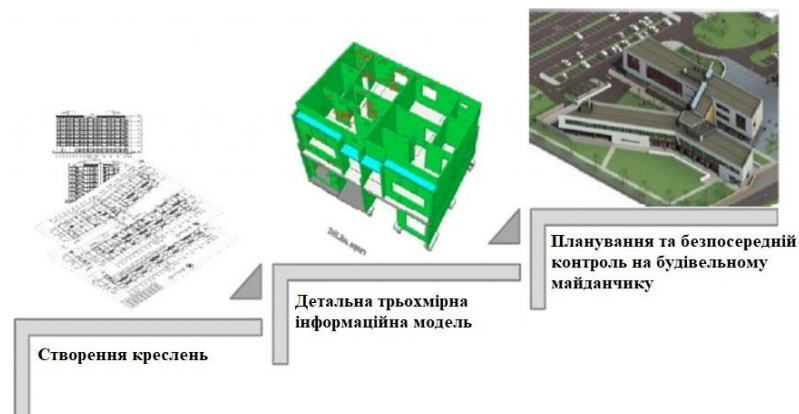
Рис. 1.7 Традиційна схема моніторингу та планування будівництва
