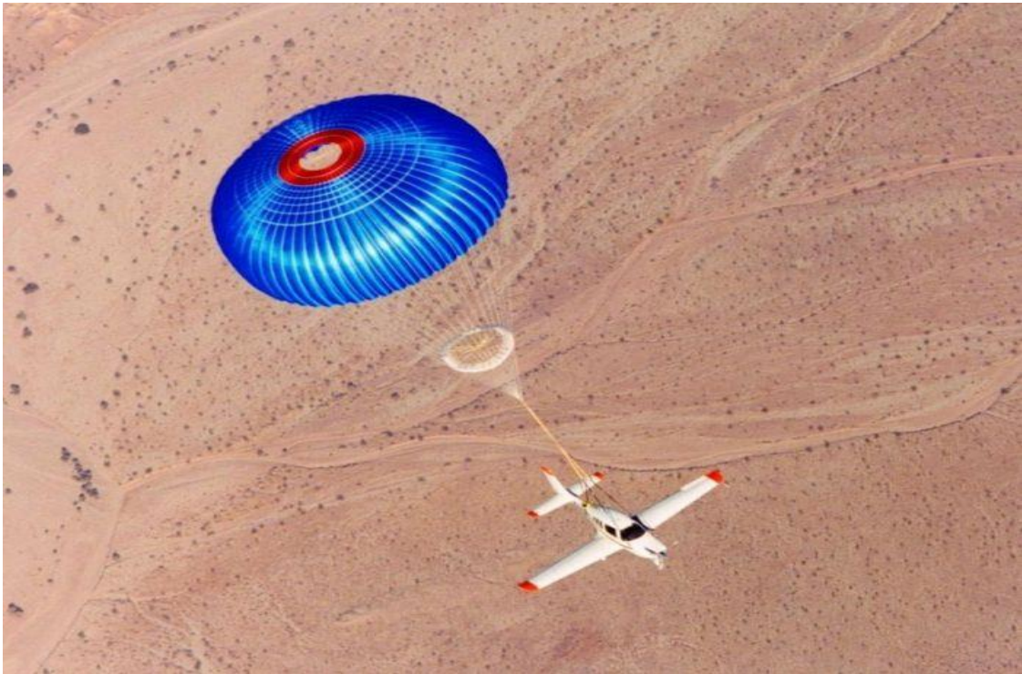
Рисунок 4.6 – Застосування системи ШПС при повній втраті керованості
