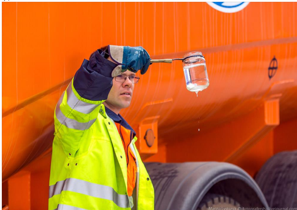
Рисунок 2.10 – Перевірка якості палива із бака паливозаправника (ПС)
