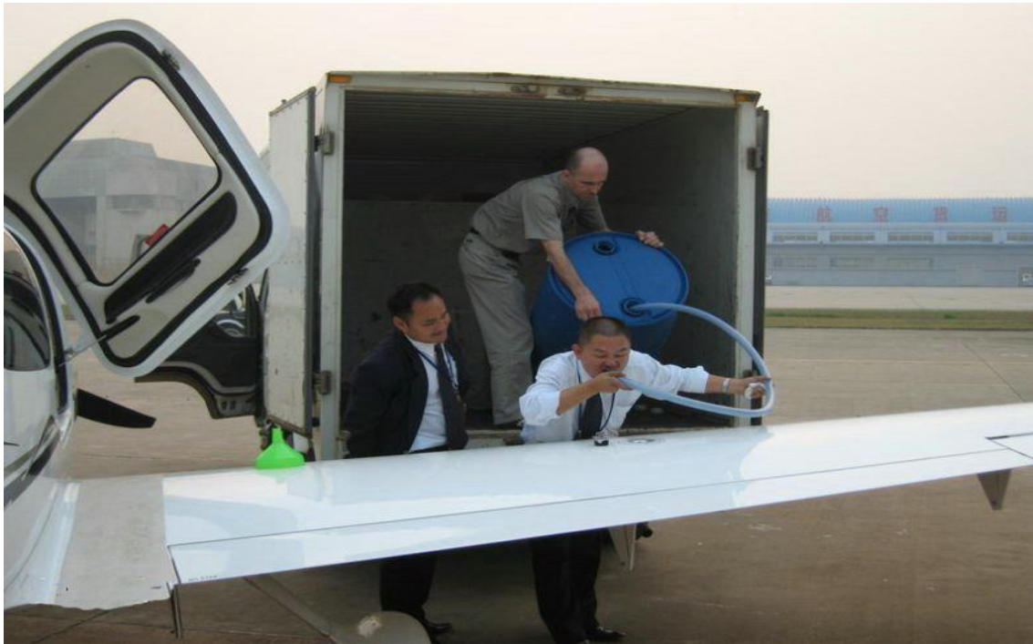
Рисунок 2.11 – Заборонений спосіб заправки паливом ПС
