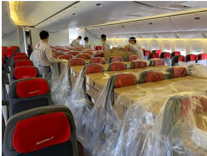
Рисунок 1.7. – Переобладнання літаків під перевезення спеціальних вантажів Джерело [67]
