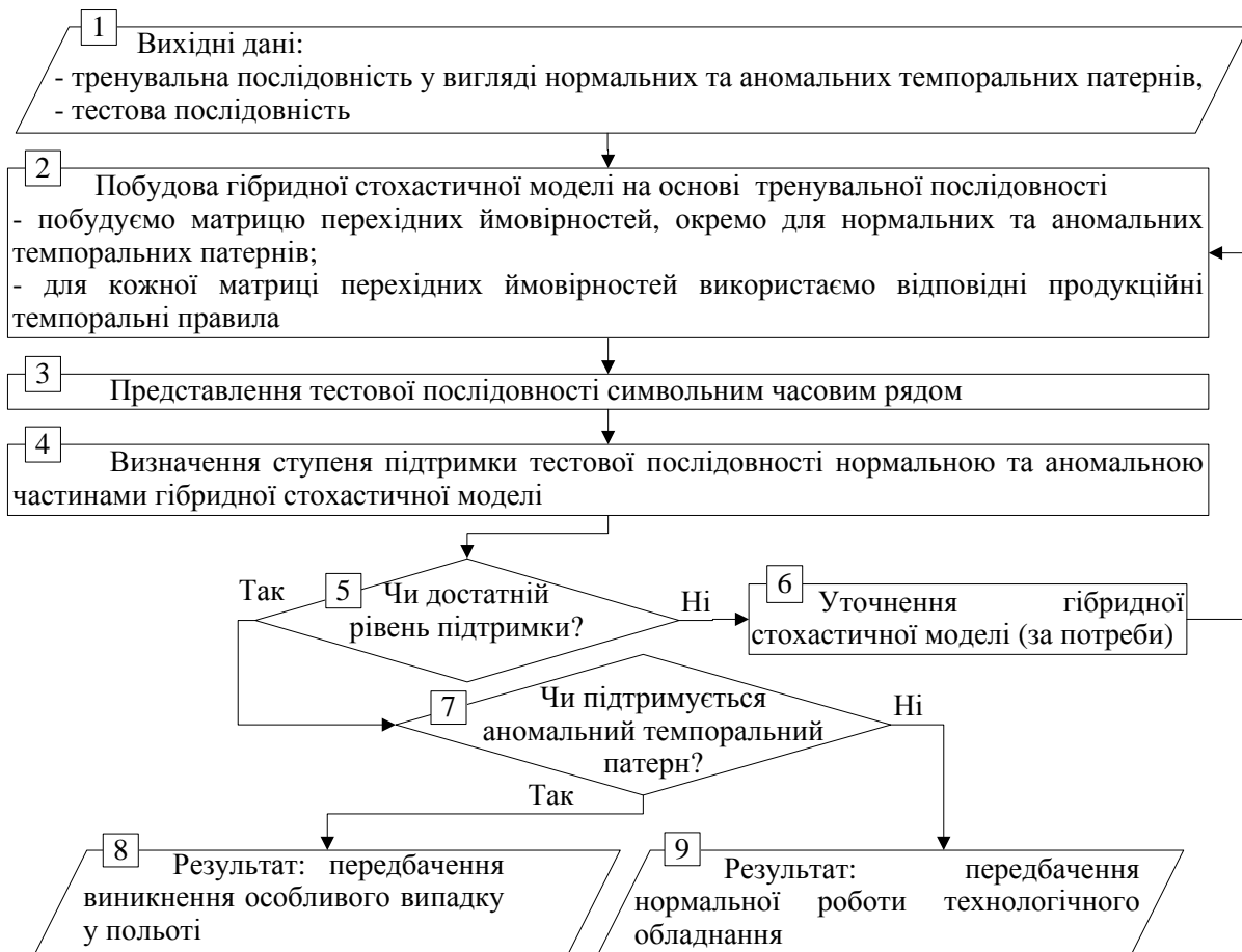
Рисунок 3.8 – Структура методу передбачення особливих випадків у польоті на основі завчасного виявлення аномальних послідовностей у діагностичних даних технологічного обладнання повітряного судна
