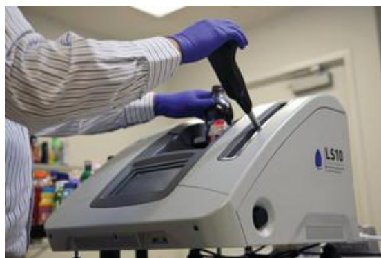
Рисунок 3 – Система для ідентифікації небезпечних рідин LS10 bottlescanner
