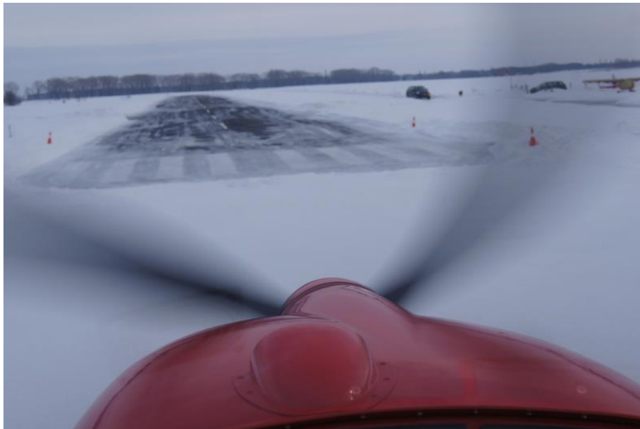
Рисунок 2.22 - Когда коэффициент сцепления мал и часто изменяется, его значение может передаваться непосредственно диспетчером
