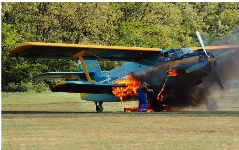
Рисунок 2.5 - Пожар на самолете Ан- 2 при запуске двигателя из -за неисправности топливной аппаратуры
