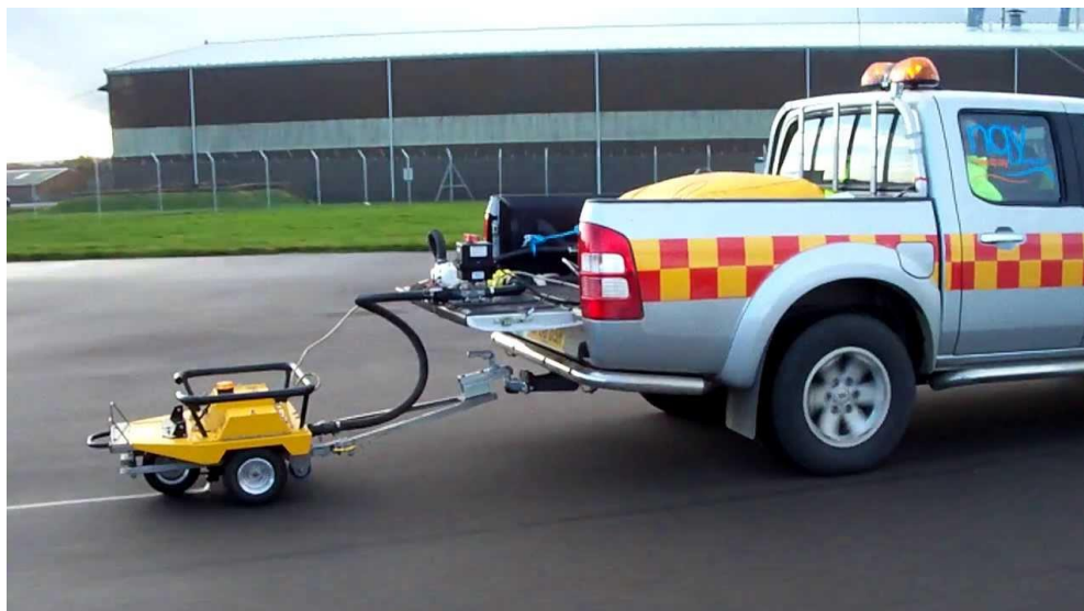
Рисунок 2.21 - Устройство измерения замера «коэффициента сцепления»
