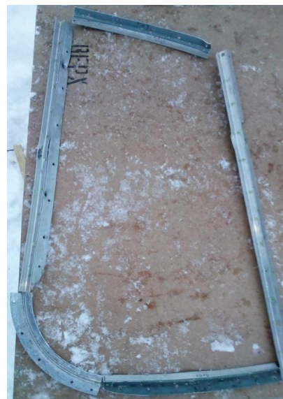
Рис.5. Кріплення оглядового бокового (правого) скла
