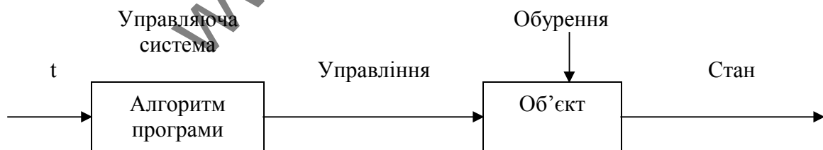
Рис.1. Принцип розімкнутого управління.
