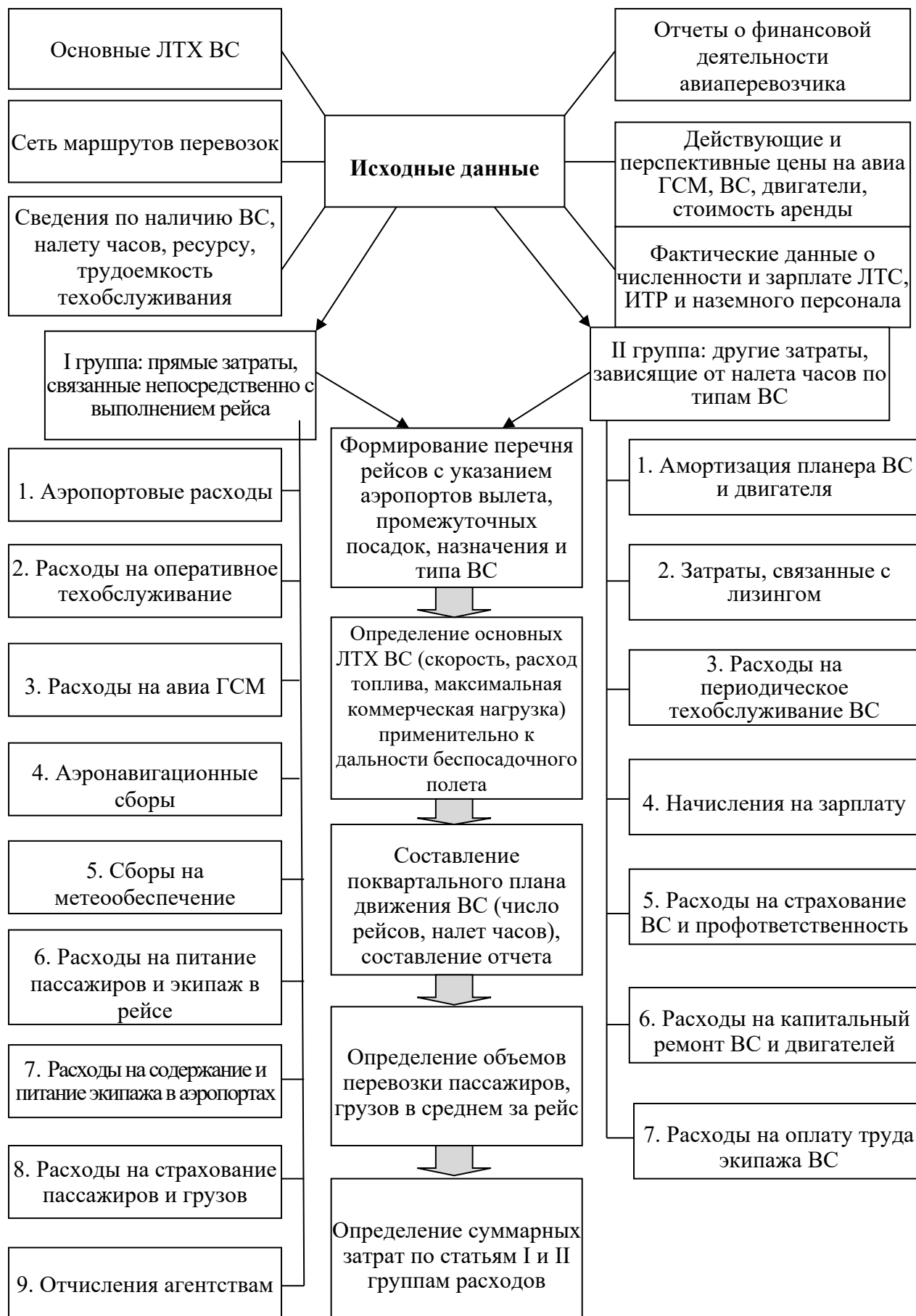
Рис. 1. Общая схема информационного обеспечения уточненного определения себестоимости рейсов авиаперевозки пассажиров ВС
