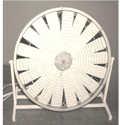
Рис. 8 – Конструкція випромінюючого вузла світлодіодного прожектора
