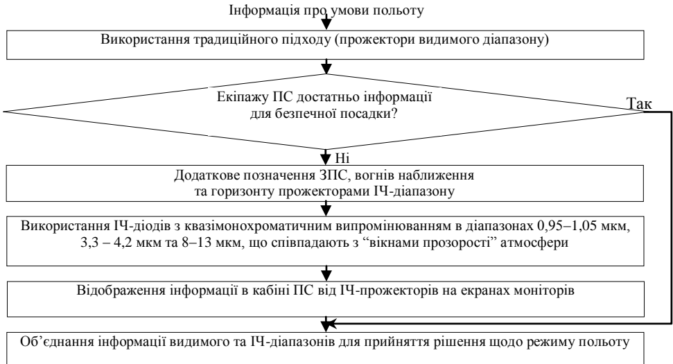
Рис. 6 – Структура методу спостереження світлових та ІЧ-сигналів під час супроводу повітряних суден при посадці у складних метеорологічних умовах
