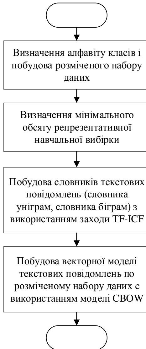
Рисунок 2 Узагальнена структура методу формування навчальної вибірки для навчання глибокої гібридної нейронної мережі прогнозування несприятливих авіаційних подій в польоті
