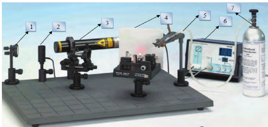
Рисунок 31 Визначення індексу \text{CO}_2 при використанні інтерферометра Майкельсона
