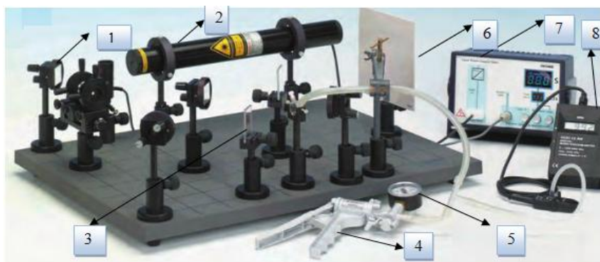
Рисунок 32 Визначення індексу заломлення повітря при використанні інтерферометра Маха-Цендера
