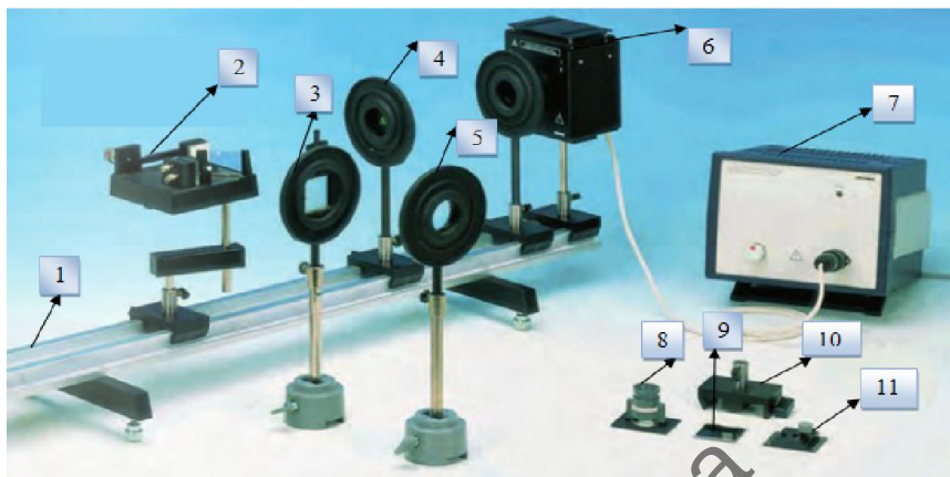
Рисунок 30 Дослідження когерентії світла з спектральними лініями, використовуючи інтерферометр Майкельсона
